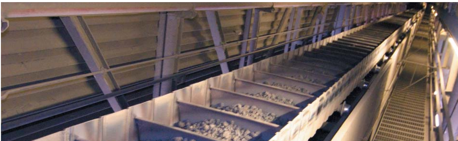
45°の傾斜のKZB-Q型コンベアー
