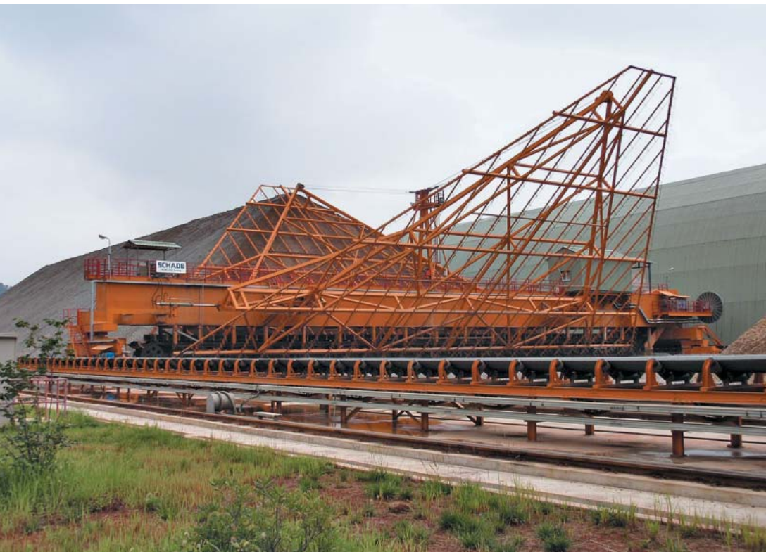
石灰石用のブリッジ型スクレイパーリクレイマー
