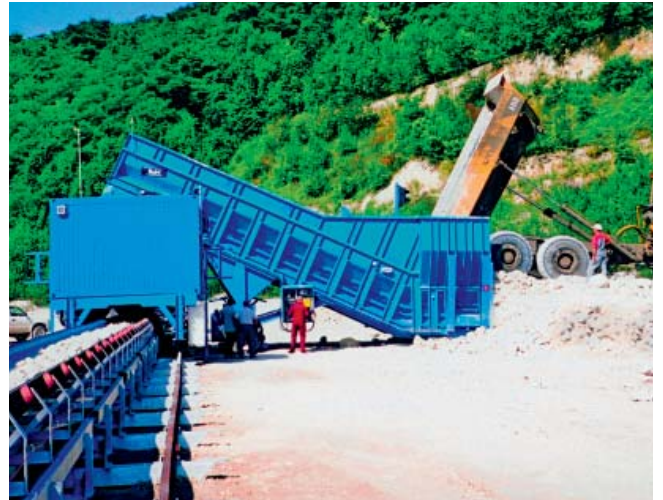
SAMSON™フィーダー — 採石場での粉砕機への投入
