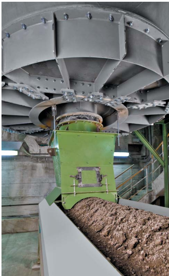
CENTREX™による天然石こう、凝灰岩の引き出し
