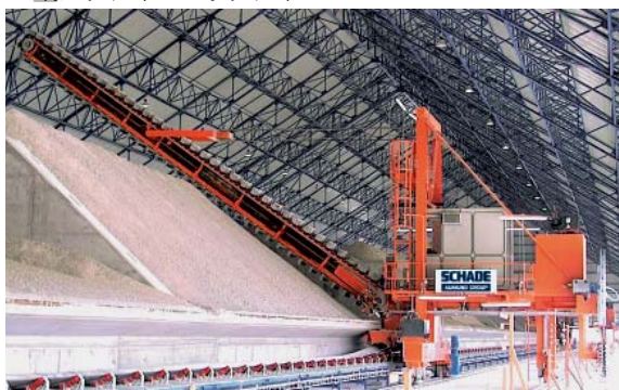
混合材、回収可能物資などのためのカンチレバー型スクレイパーリクレイマー
