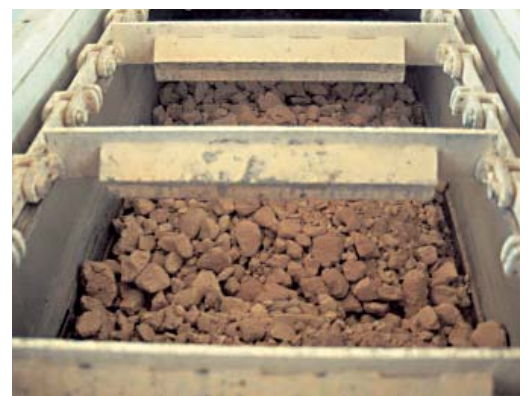
石灰石を搬送するチェーンコンベアー
