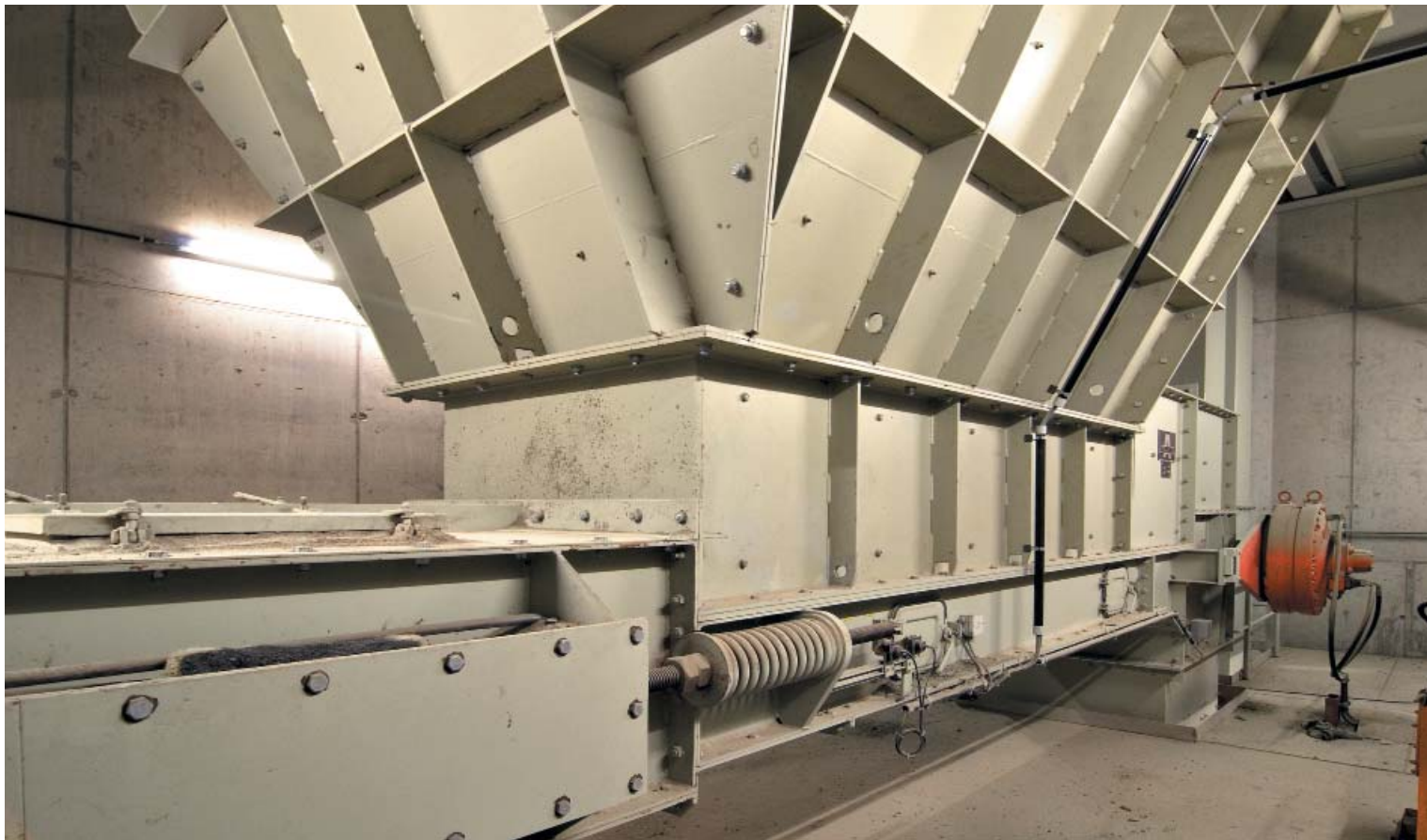
ホッパーディスチャージ用の重装備型チェーンコンベアー
