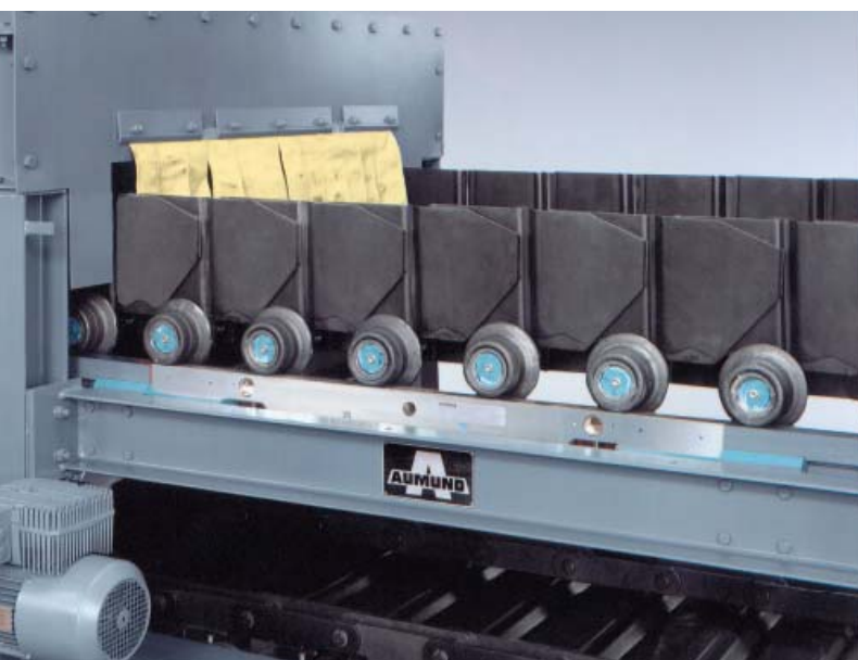
深絞り型パンを装備したエプロン型検量フィーダー
