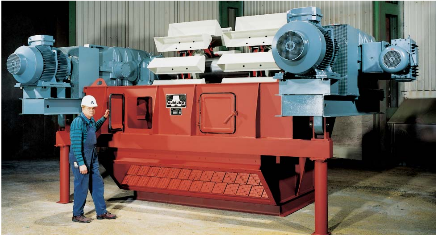
ダブルバケットエレベーターのヘッド部、ダブルドライブ及び二組のバケット
