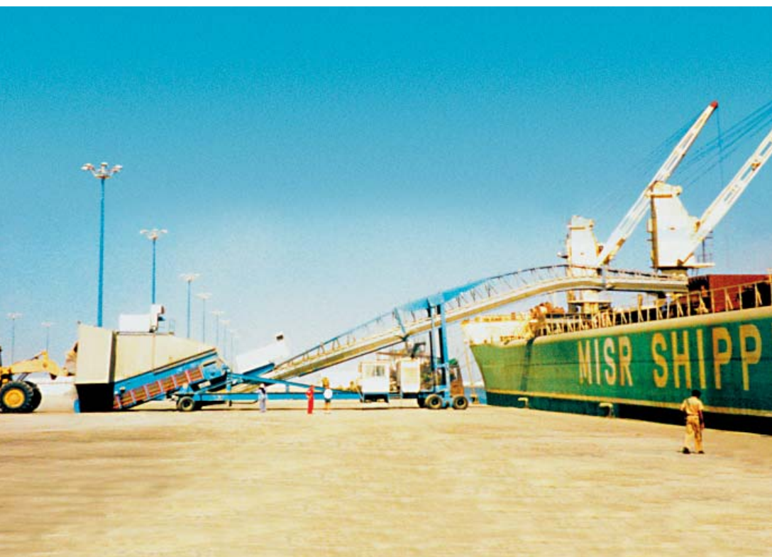
SAMSON™フィーダーを装備したクリンカー輸出用移動型シップローダー
